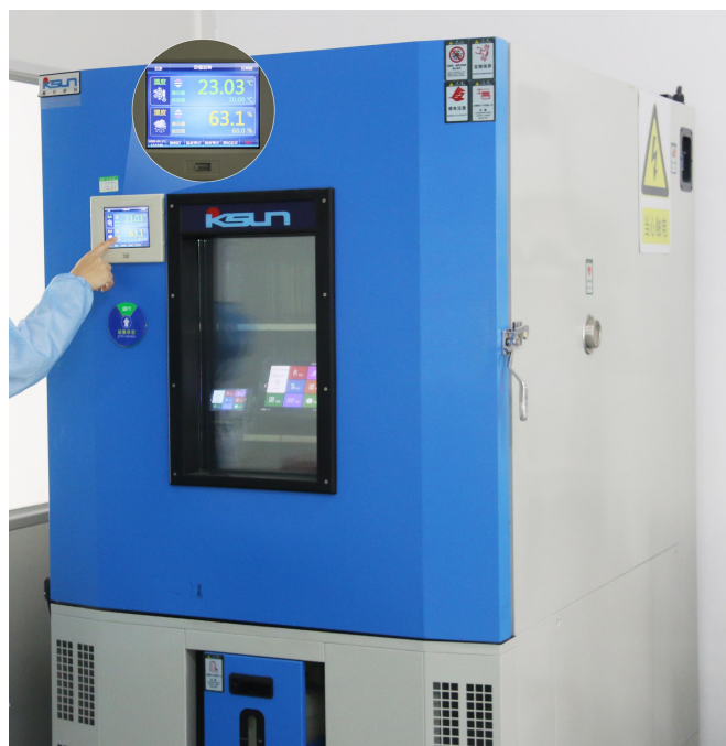
图 4-8 高低温老化测试图
